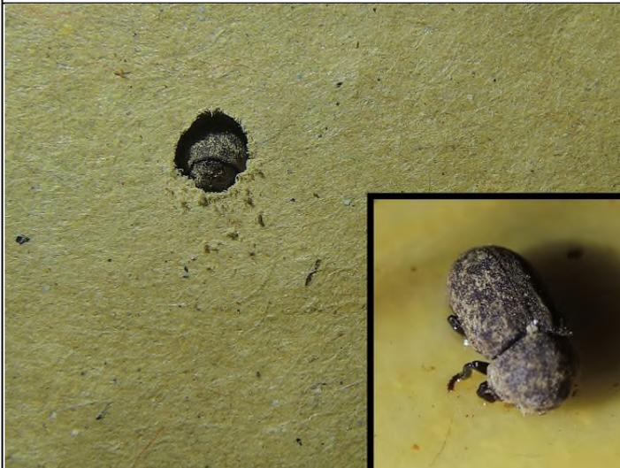
Abb. 66: Käfer schaut aus einem Balken hervor. Der Balken ist für ein Monitoring abgeklebt, der Käfer hat sich durch das Papier gefressen. Eckbild: Käfer auf einer Klebefalle.
