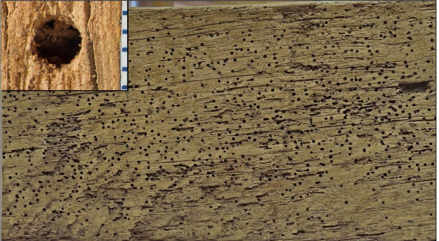
Abb. 9: Alte Dachstuhl-Strebe: derzeit nicht bewittert, trocken und vierseitig umlüftet (der Rand weist eine typische Alterung durch eine Bewitterung auf – oben links); Eichenholz mit starken Schäden durch den Gescheckten Nagekäfer, die Spanne der Schäden ist groß; vgl. Abb. 8; Fäulschäden von außen wenig sichtbar; das Holz ist nicht mehr nagelfest; Eckbild: Ausschlupfloch; Maßstab in Millimetern.
