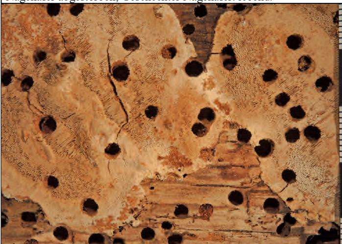
Abb. 12: Fruchtkörper des Ausbreiteten Hausporlings mit Insektenausschlupf-Löchern von *Xestobium rufovillosum*; die Löcher sind wieder zugewachsen; Maßstab mit Milli- und Zentimetern.
