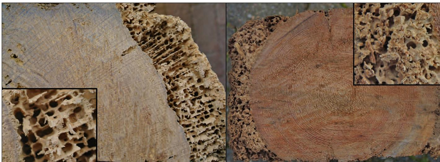
Abb. 4: Typisches Fraßbild des Gescheckten Nagekäfers an Eichen-Splintholz: Das Splintholz wurde massiv zerstört, der Kernholzanteil wurde weniger befallen. Fäule-Schäden sind durch Moderfäulepilze und Kellerschwamm im Randbereich vorhanden; Eckbild: Splint.
