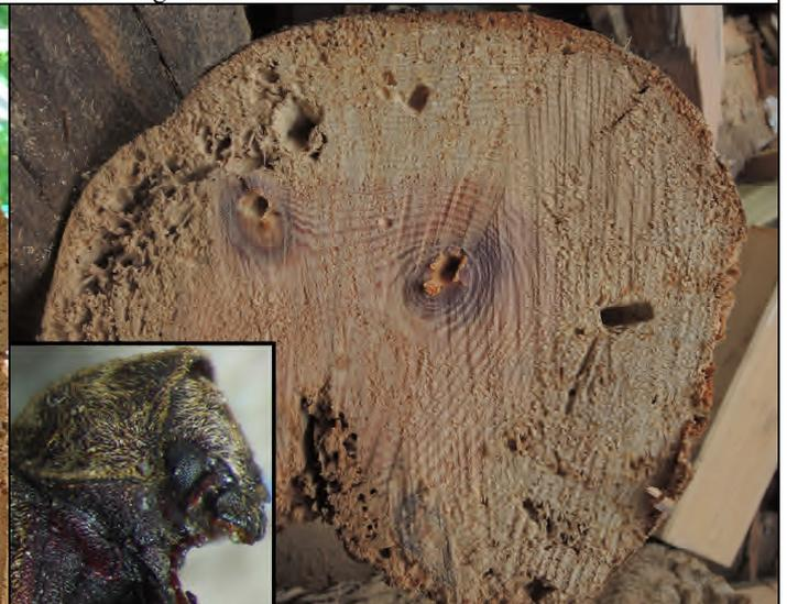
Abb. 28: Nadelholzbalken mit Braunfäule im Splint- und im Kernholz: Nur die faulen Teile wurden vom Gescheckten Nagekäfer besiedelt.
