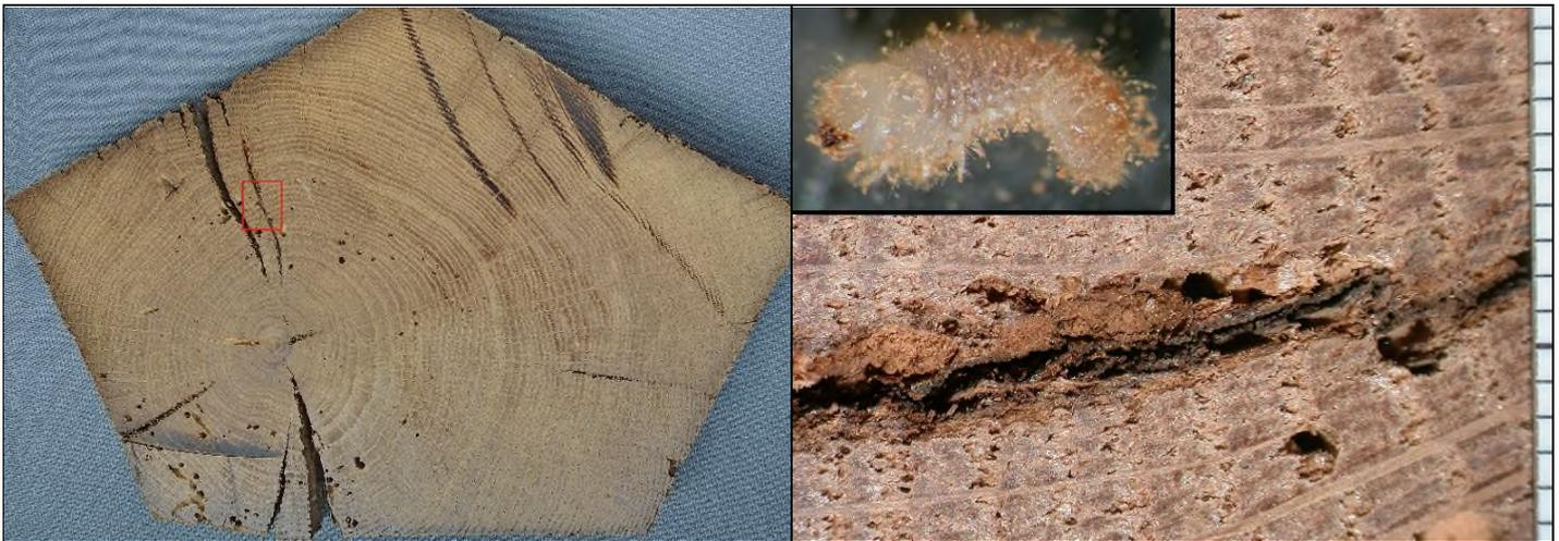
Abb. 22: Dem ersten Augenschein nach gesundes Eichenkernholz mit Trockenrissen aus einem Kirchturm in Süddeutschland: Kleinstäumiger Kombinationsbefall in den eingeschlossenen Holzrissen und in den ersten 25 Jahrringen.
