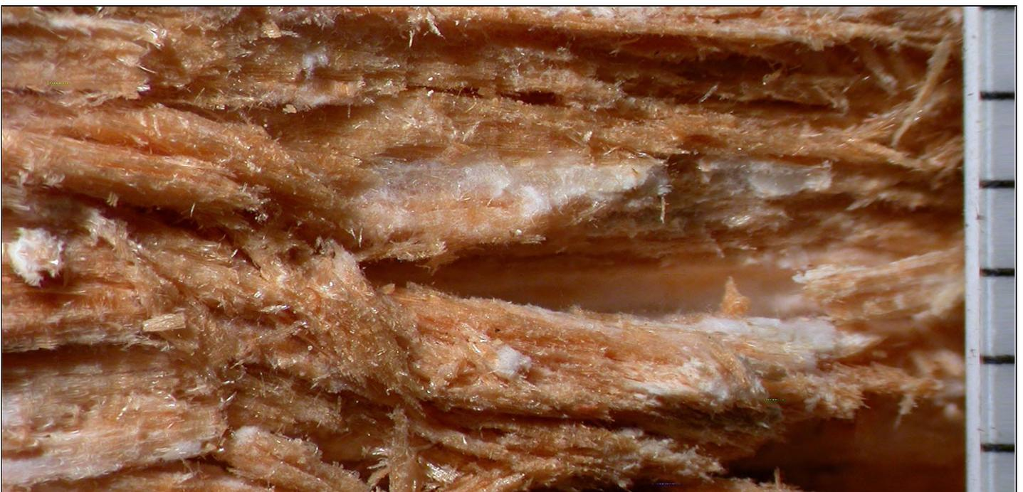
Abb. 15: Feines, weißes Mycel des Ausgebreiteten Hausporlings (*Donkioporia expansa*) in einem Holzbauteil; die eiweißreichen Mycelien bilden die Grundlage für ein schnelleres Wachstum des Gescheckten Nagekäfers; oft finden sich Konidien (Abb. 14); Maßstab mit Millimetern.
