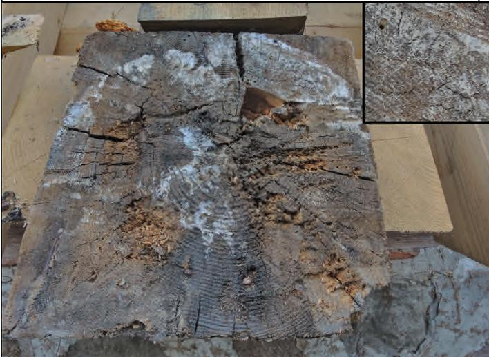
Abb. 19: Balkenkopf Nr. 9: Befall mit Echem Hausschwamm mit sehr wenig Befall des Gescheckten Nagekäfers. Entfernung zum Moderfäule-Schaden von Abb. 20: wenige Meter; Eckbild: Mycel-Detail.
