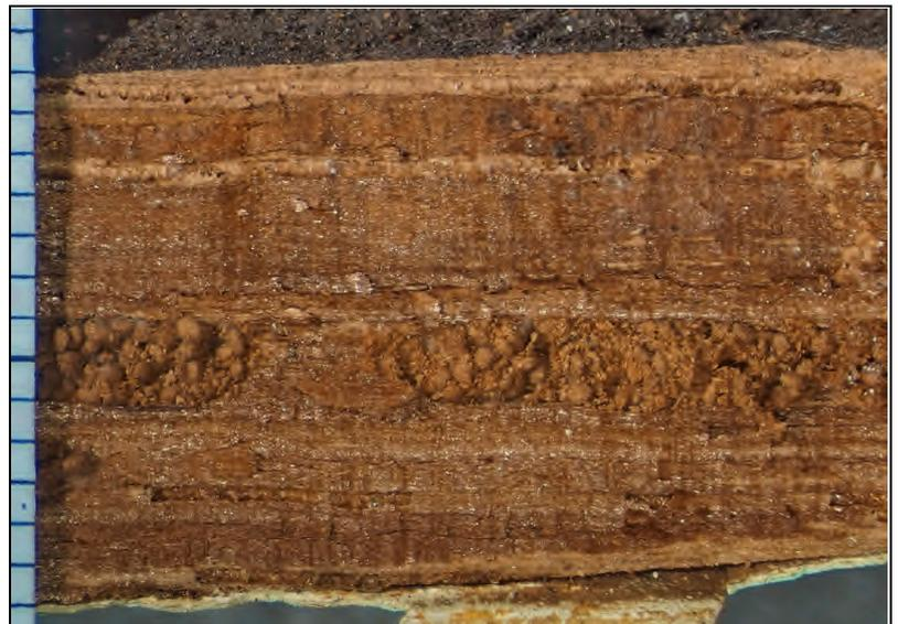
Abb. 50: Dünne Eichenplatte mit Moderfäulepilz-Befall und Schaden durch den Geseckten Nagekäfer (nicht aus Probsteierhagen).
