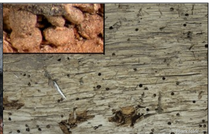
Abb. 6: Kernholz der Eiche mit Befall von Xestobium rufovillosum und massiven Schäden durch Moderfäulepilze; Eckbild: Kotpartikel
