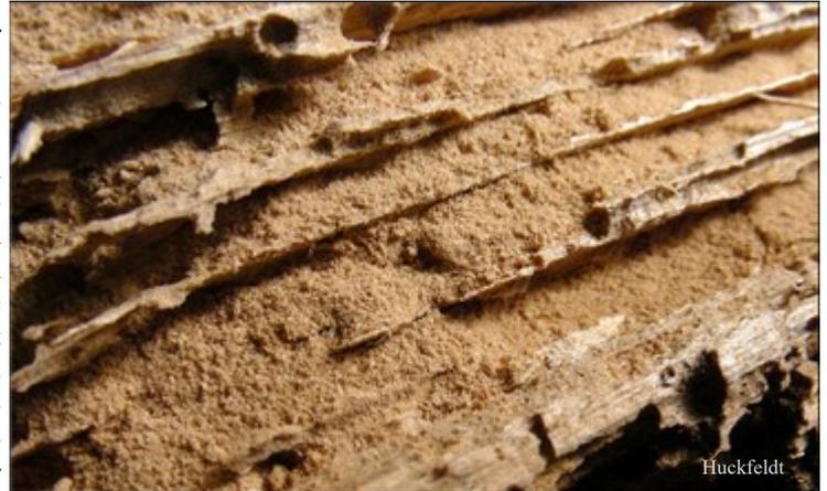
Abb. 7: Schadbild mit Bohrmehl des Schwammholz-Nagekäfers im Holz mit Fäule durch den Echten Hausschwamm; Spätholzteile verbleiben.
