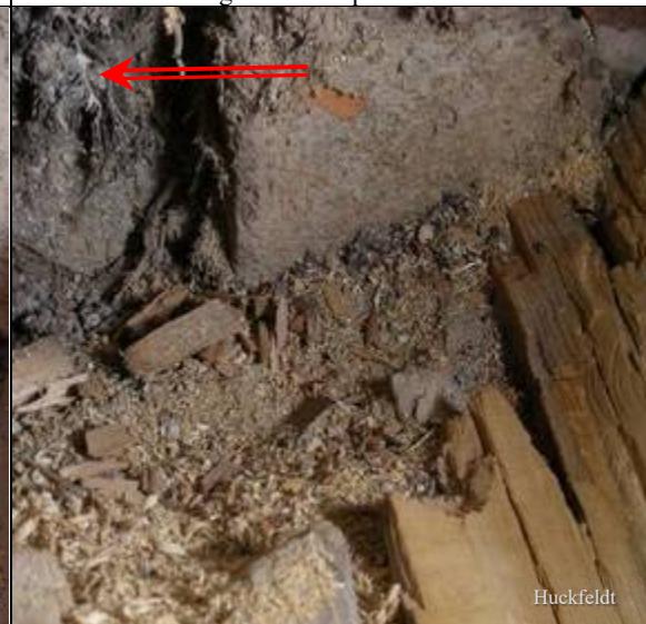
Abb. 6: Detail von Abb. 5: Ein günstiges Stück zur Probeneinsendung (Pfeil); bitte zusammen mit etwas faulem Holz einsenden oder gern mehr Material.
