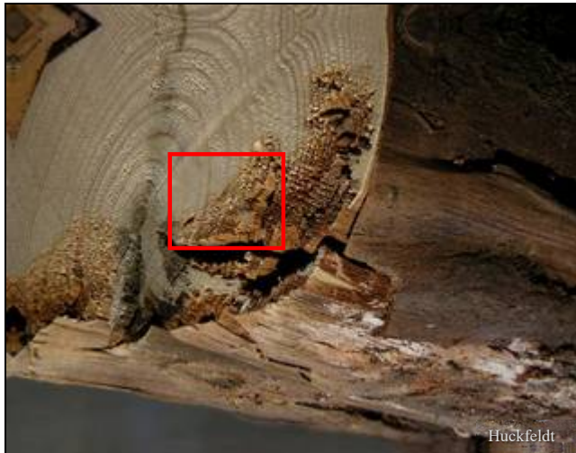
Abb. 1: Lagerholz mit Braunfäule; Mycel fehlt; die Probe sollte aus dem Übergang vom gesunden zum zerstörten Holz entnommen werden.
